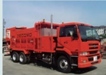
連続練りミキサーを搭載した大型の移動式コンクリートミキシングシステム。高品質な超速硬コンクリートをいつでもどこでも供給可能です。1時間あたりの供給能力は5~10m<sup>3</sup>です。繊維補強タイプも供給可能です。
