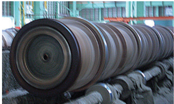
コンクリートパイル製造状況
