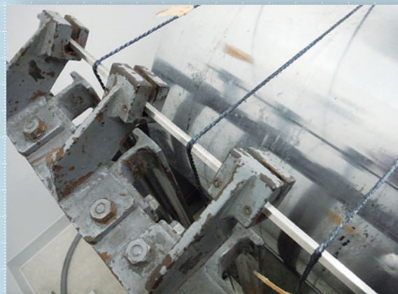
試験体 摩耗状況
