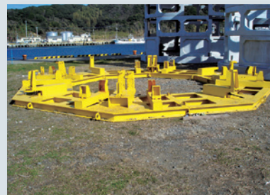
下端リング組立専用足場
