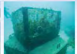
3年経過後(破損無し)
